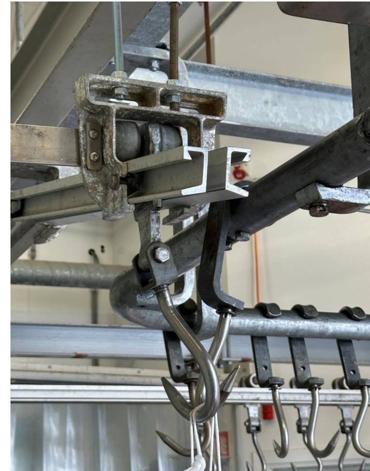
Umskipti á kjötkrókum í kjötmóttöku Ferskra kjötvara (krókur til vinstri frá birgja) á braut smíðaðri í maí-júní 2025.
